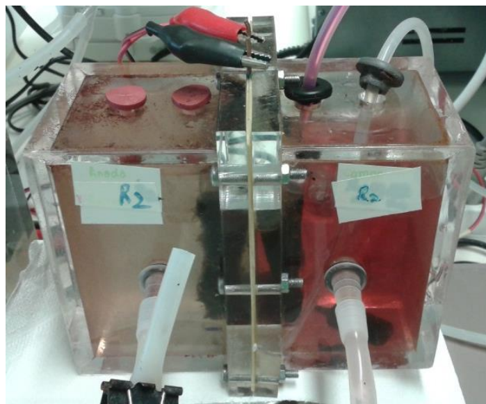
Figura 12 – MFC com permanganato de potássio na câmara do cátodo abiótico, exibindo uma cor avermelhada.
