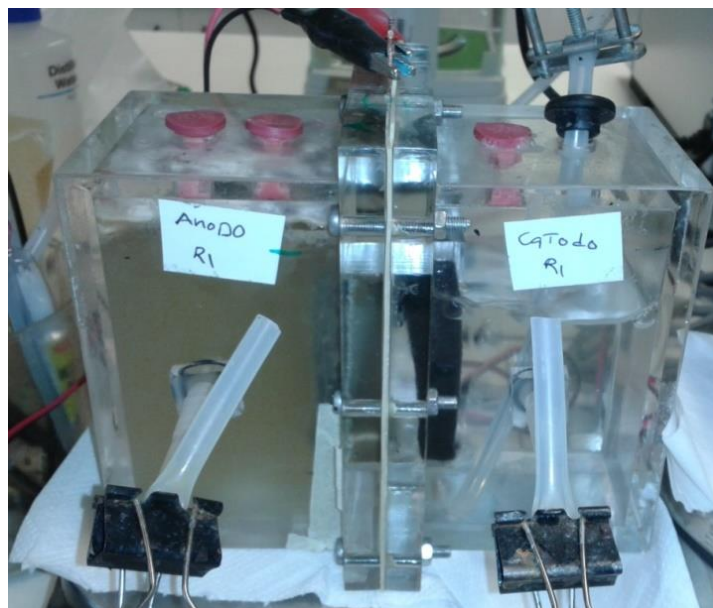
Figura 13 – MFC com soro de leite no compartimento anódico.
