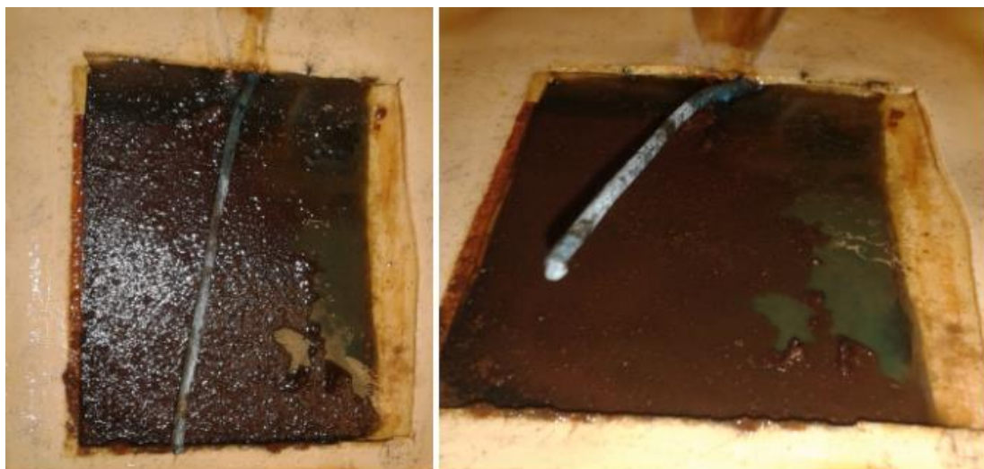
Figura 32 – Biofilme formado entre o eletrodo do compartimento anódico e a membrana de Nafion .
