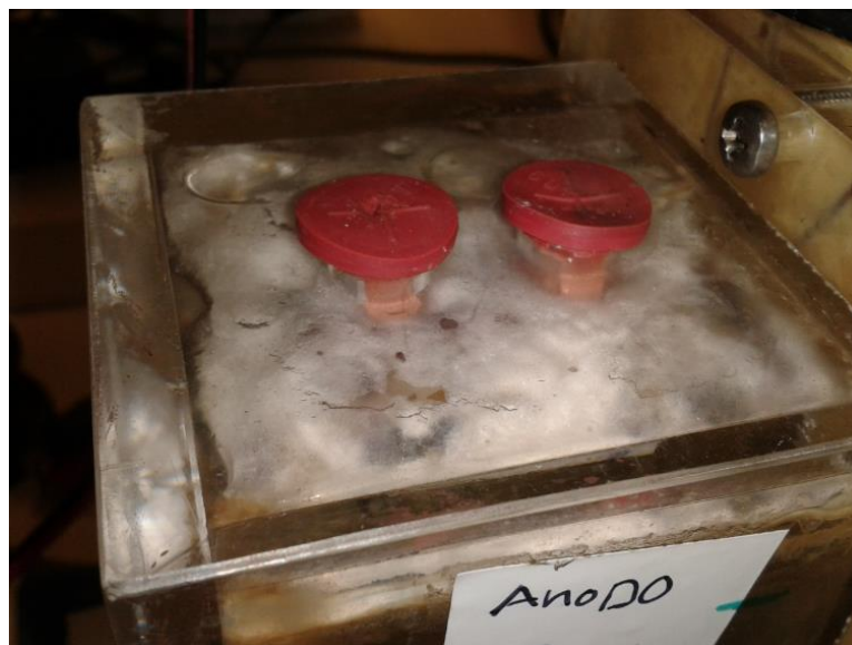
Figura 29 – MFC com soro de leite contaminada por fungos, micróbios patogénicos, esporos, entre outros.
